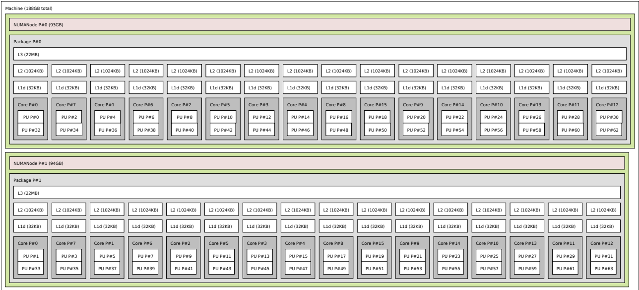
FIGURE 8.12 – Un noeud de calcul d’un cluster récent (2018). Deux processeurs (Intel Xeon Gold 6130), 16 coeurs par processeur, deux threads SMT par coeur. Chaque coeur possède 32Ko de cache L1 (partagé entre les 2 threads) et un gros cache L2 de 1Mo. Un cache L3 de 22Mo est partagé entre tous les coeurs. Chaque processeur possède son propre controleur mémoire et accède de manière privilégiée à « ses » 96Go de RAM. Il y a donc deux noeuds NUMA.
